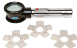
Elcometer 127 může být použit v souladu s ASTM D 4417 metoda A.
